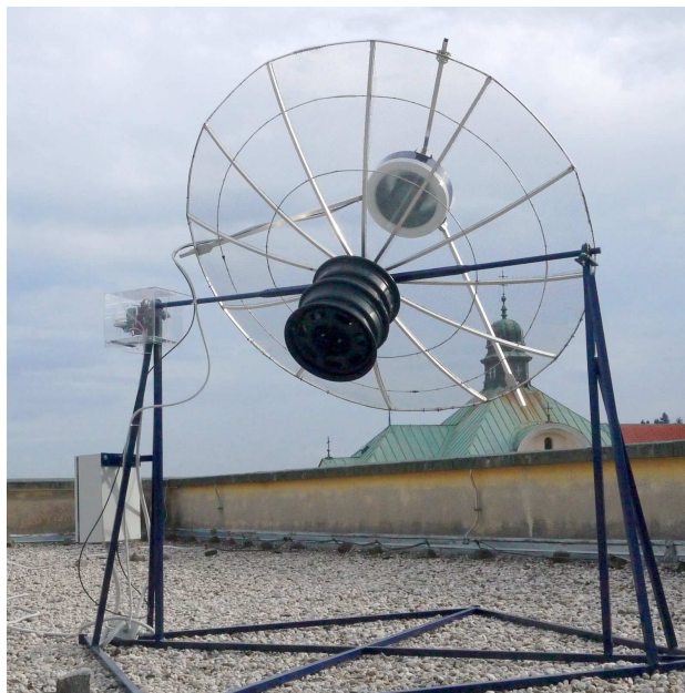
Parabolična antena na terasi Gimnazije Šentvid - Ljubljana. Vir: AD Vega
