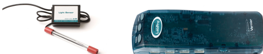
Slika 5.3: Na levi strani je Vernierov senzor svetlobe, na desni pa Vernierov vmesnik za računalnik (LabPro).
