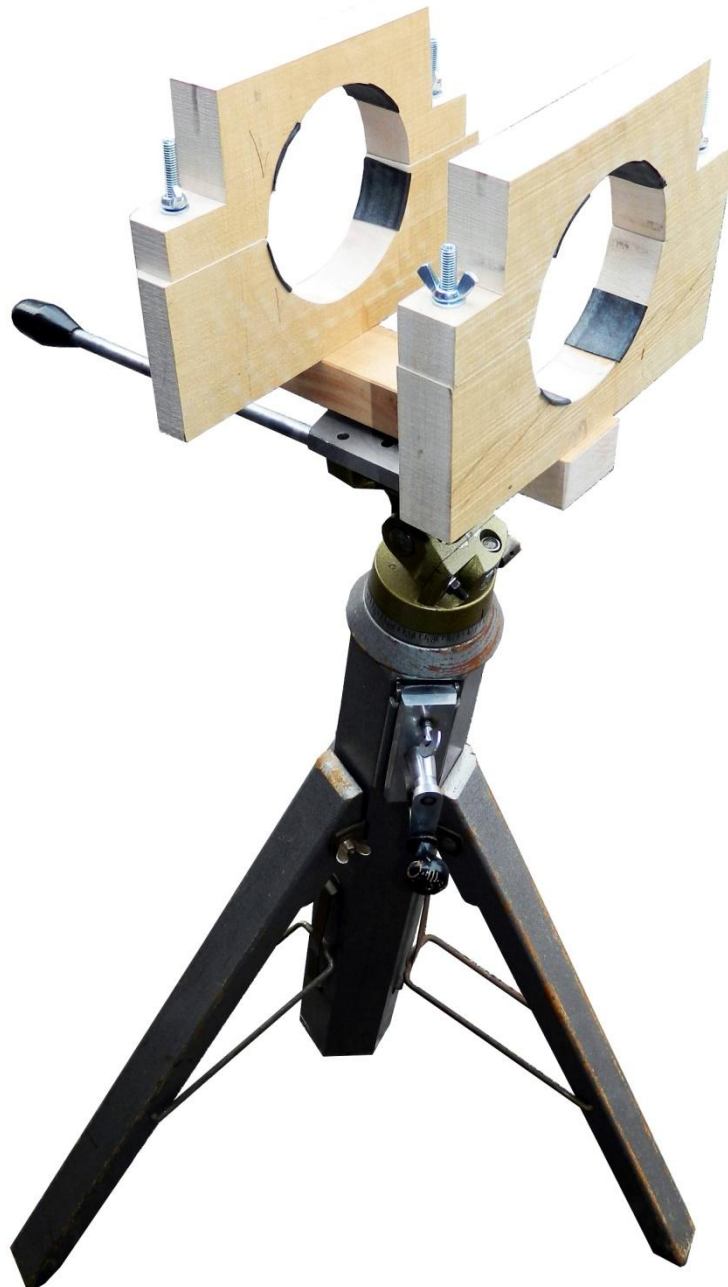
Slika 11: Leseno stojalo in držalo za optično cev.
